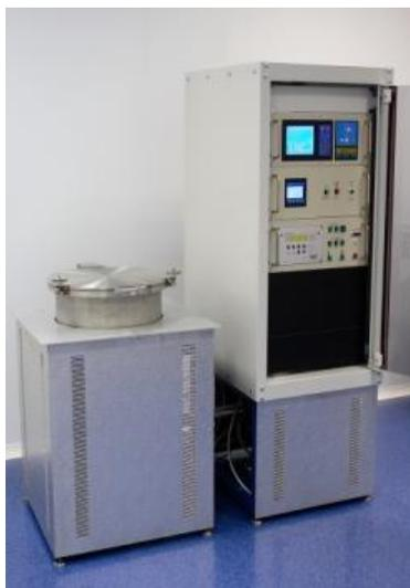
Предназначена для проведения технологических процессов отжига и термического обезгаживания изделий электронной техники в высоком вакууме.
