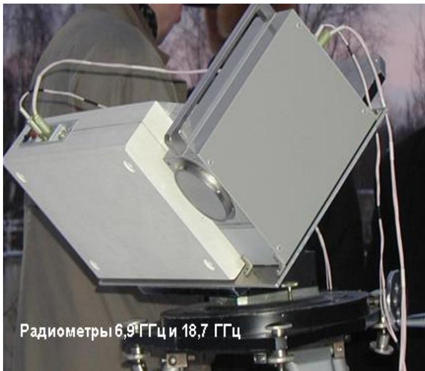
Предназначен для измерения физических параметров снега на двух ортогональных поляризациях дистанционным пассивным методом по собственному излучению снежных покровов. Включает четыре радиометра: РП-6,9; РП-18,7; РП-37; РП-85.
