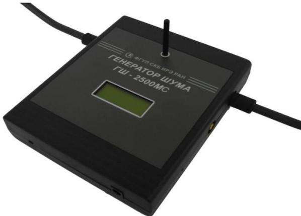
ГШ-2500МС (исполнение ТИДН.464217.010), далее по тексту генератор, является техническим средством типа «А» и «Б» активной защиты информации и предназначен для маскировки информативных ПЭМИН персональных компьютеров, рабочих станций на объектах вычислительной техники до 2 категории включительно путём формирования и излучения в окружающее пространство электромагнитного поля шума и путём наведения маскирующего сигнала в отходящие цепи и инженерные коммуникации в широком диапазоне частот.
