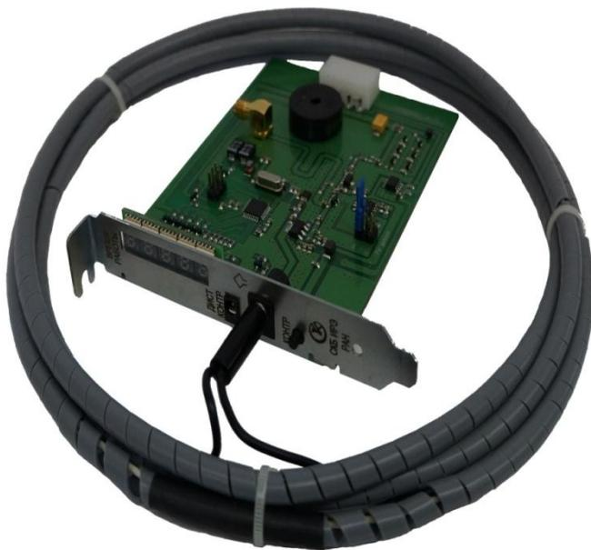
Генератор шума ГШ-К-1800МС, далее по тексту генератор, является техническим средством типа «А» активной защиты информации и предназначен для маскировки информативных побочных электромагнитных излучений (ПЭМИ) персональных компьютеров, рабочих станций на объектах вычислительной техники до 2 категории включительно путем формирования и излучения в окружающее пространство электромагнитного поля шума в широком диапазоне частот.
