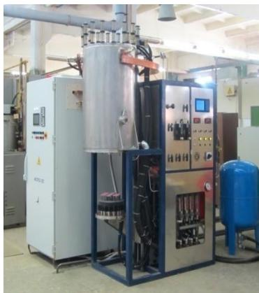
Предназначена для термической обработки изделий в среде водорода и азота при температурах до 2000 °С.
