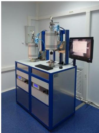
Предназначена для термокомпрессионной сварки полупроводниковых структур со стеклянными подложками в вакууме при температурах до 700 °С.
