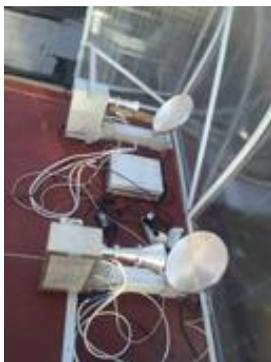
Предназначен для измерения спектра радиояркой температуры облаков с целью определения их влагосодержания и может использоваться для прогнозирования условий радиосвязи и повышения точности позиционирования для систем навигации.
