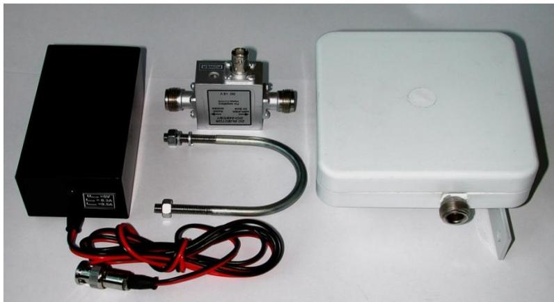
Предназначена для работы совместно с радиомодемами стандарта IEEE 802.11b в полудуплексном режиме. Используется для компенсации потерь в кабеле, увеличения дальности связи и повышения её качества. Активная антенна представляет собой плоскую антенну с усилением 10 дБ со встроенным двунаправленным усилителем. Усилитель имеет в своём составе грозозащитник и полосовой фильтр, обеспечивающий подавление внеполосных помех.
