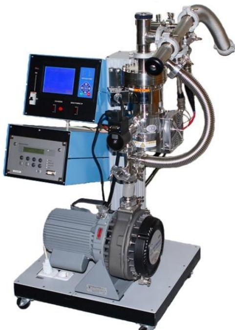
Разрабатываются и изготавливаются передвижные вакуумные посты различной производительности на базе турбомолекулярных, мембранных, спиральных и других насосов. В том числе компактные передвижные автоматические откачные системы, в состав которых могут входить:
