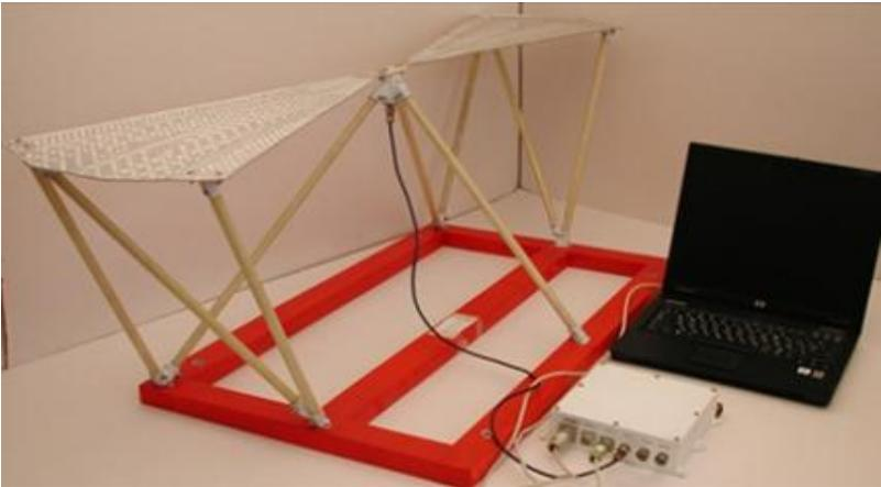
Предназначен для исследования поверхности и подповерхностной структуры грунта спутника планеты Марс Фобоса с целью оценки диэлектрических свойств грунта и обнаружения литологических слоев на глубинах 1...100 м.
