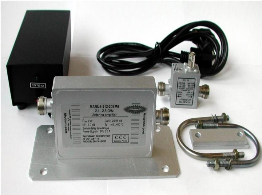
Предназначен для работы совместно с радиомодемами стандарта IEEE 802.11b в полудуплексном режиме. Усилитель обеспечивает компенсацию потерь в кабеле при приёме и передаче сигнала, увеличение дальности связи и повышение её качества. Имеет в своём составе встроенный грозозащитник и полосовой фильтр, обеспечивающий подавление внеполосных помех. Может изготавливаться с заданным усилением по требованию заказчика.
