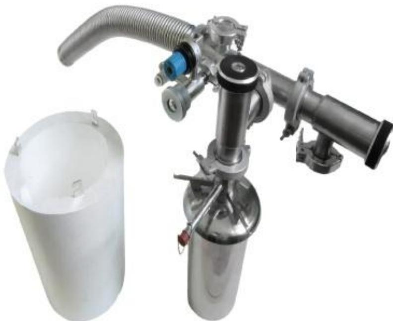
Изготавливаются цеолитовые насосы, дополнительно комплектуемые трубопроводной арматурой, регулирующими вентилями, печью для регенерации, сосудом Дьюара.
