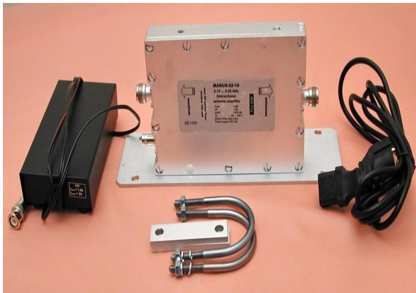
Предназначен для работы совместно с радиомодемами стандарта IEEE 802.11a в полудуплексном режиме. Усилитель обеспечивает компенсацию потерь в кабеле при приёме и передаче сигнала, увеличение дальности связи и повышение её качества. Имеет в своём составе встроенный грозозащитник. Для передачи данных могут быть использованы следующие типы модуляции: BPSK, QPSK, CCK, 16-QAM. Может изготавливаться с заданным усилением по требованию заказчика.
