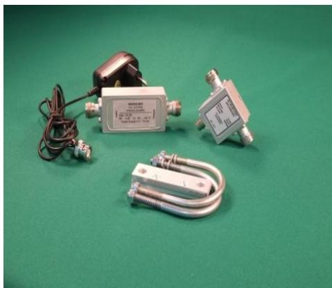
Предназначен для работы совместно с радиомодемами стандарта IEEE 802.11b в дуплексном режиме. Усилитель обеспечивает компенсацию потерь в кабеле и улучшение чувствительности приёмного канала. Имеет в своём составе встроенный грозозащитник и полосовой фильтр, обеспечивающий подавление внеполосных помех.
