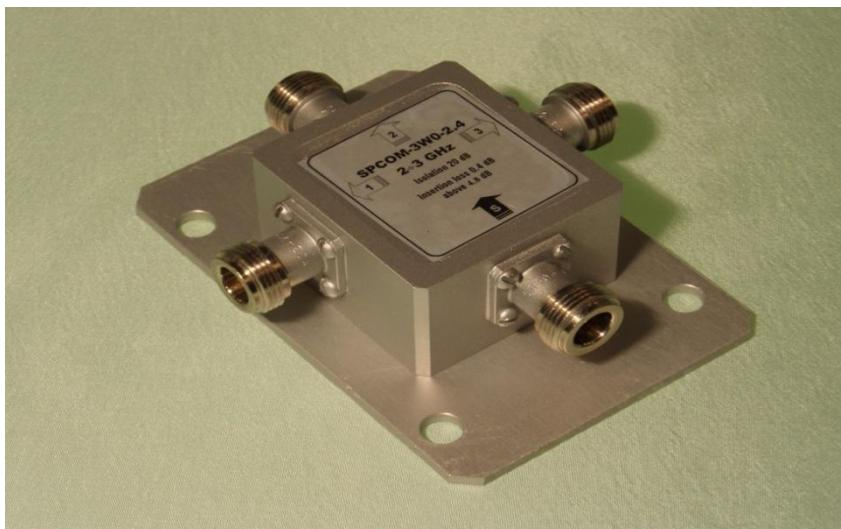
Предназначен для равного деления СВЧ мощности на три канала. Применяется при измерениях параметров СВЧ устройств, настройке и ремонте СВЧ аппаратуры и в приёмо-передающих трактах систем связи.
