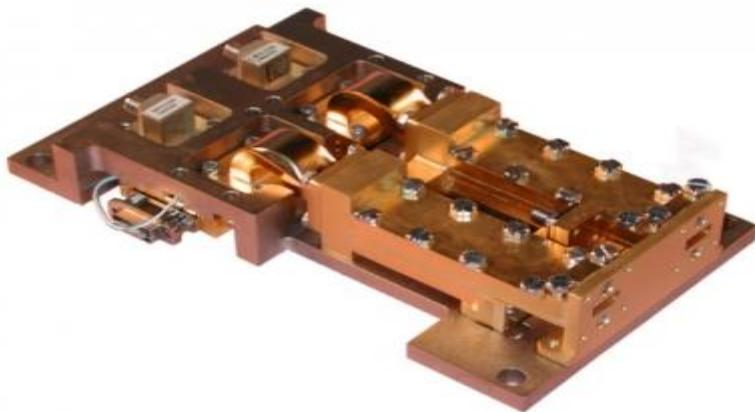
Малозумящий усилитель (МШУ) предназначен для усиления сигнала с антенного облучателя радиометра.
