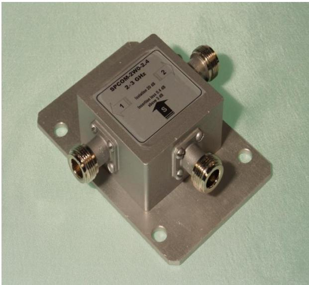
Предназначен для равного деления СВЧ мощности на два канала. Применяется при измерениях параметров СВЧ устройств, настройке и ремонте СВЧ аппаратуры и в приёмопередающих трактах систем связи.
