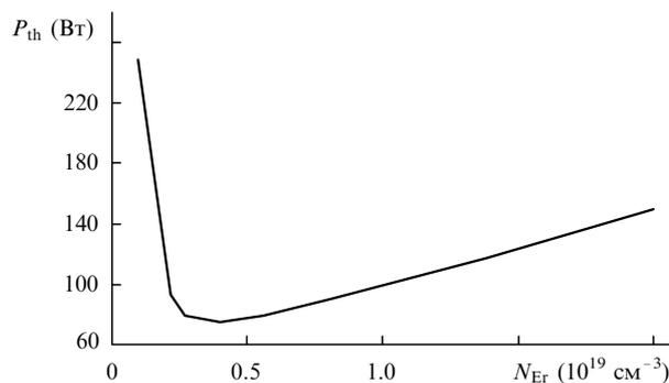
Рис. 1. Расчетная зависимость пороговой мощности накачки  $P_{th}$  от концентрации ионов эрбия  $N_{Er}$  для АЭ размером  $\varnothing 2.7 \times 80 \text{ мм}$  и  $R_{out} = 96 \%$ .
